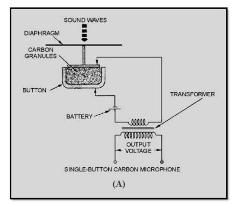
Figure 1-33A Carbon microphones. SINGLE-BUTTON CARBON MICROPHONE
