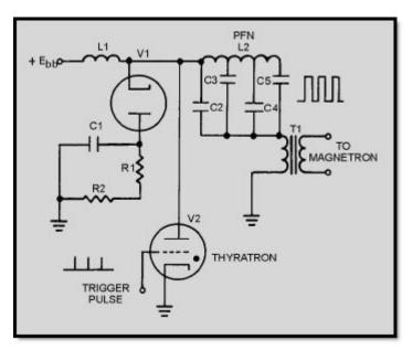
Figure 2-39 Typical thyratron gas-tube modulator
